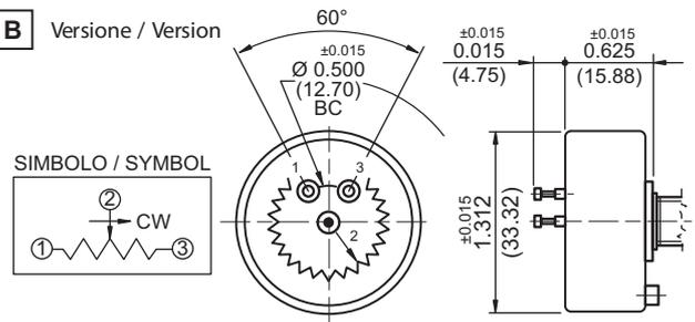
**Potenziometro rotativo - Spinning potentiometer**
