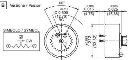
**Potenziorometro rotativo - Spinning potentiometer**
