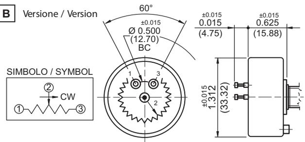
**Potenziometro rotativo - Spinning potentiometer**
