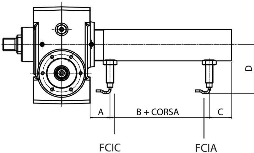
FCIC = Finecorsa induttivo chiusura
